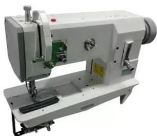
Прямострочная одноигольная машина с унисонной подачей материала и увеличенным вертикальным челноком. Предназначена для выполнения простых и декоративных строчек при обработке средних и тяжелых материалов. Аналог PFAFF 1245.
