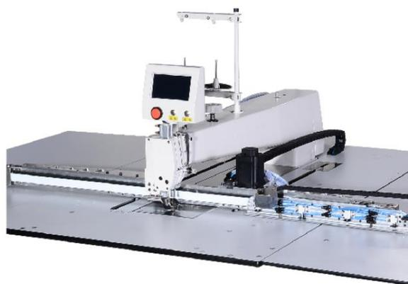
Швейный автомат применяется для пошива курток, мебельных и автомобильных чехлов. Пульт позволяет управлять параметрами шитья: рисунком шитья, количеством стежком, длиной стежков. Автомат оснащен мощным сервоприводом и высокоточной системой позиционирования зажима. Предназначен для выполнения строчек по заданному контуру в области шитья 1500x1050 мм. По требованию комплектуется стандартным или увеличенным челноком, а также игольным комплектом под легкие или тяжелые материалы.
