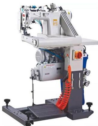
Двухигольная автоматизированное рабочее место для выполнения операции "Шов в замок" на базе П-образной машины цепного стежка с ременным пуллером и автоматическими функциями: обрезкой нити, подъемом лапки и пуллера, охлаждением иглы, вытяжкой остатков нити. Предназначена для выполнения операции «шов в замок» на легких и средних материалах при выполнении швов на рукавах и боковых швов рубашек и брюк.
