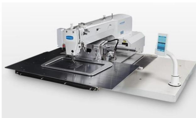
Швейный автомат программируемой строчки челночного стежка с интерфейсом для программирования шаблонов шитья, прямым приводом, автоматическим подъемом лапки, нитеотводчиком и сенсором обрыва нити. Предназначен для выполнения строчек на изделиях из средних, тяжелых и сверхтяжелых.
