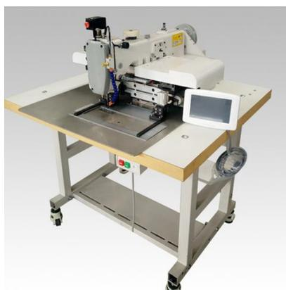
Швейный автомат программируемой строчки челночного стежка с интерфейсом для программирования произвольного рисунка шитья в заданной области, автоматическим подъемом лапки и принудительным охлаждением иглы. Опционально комплектуется горячим ножом обрезки нити. Швейный автомат предназначен для пошива изделий из тяжелых и сверхтяжелых материалов: пошив стяжных ремней, пошив тентов, спортивного инвентаря, страховочного снаряжения и каната диаметром 6-25 мм.
