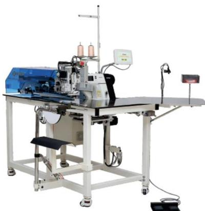
Автоматизированная машина для изготовления планки на трикотажных изделиях. Применяется для обработки воротников рубашек POLO.
