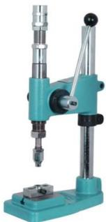
Специализированный ручной пресс в комплекте с переходниками на метрическую и дюймовую резьбу для турецких и греческих насадок. Предназначен для обтяжки пуговиц. Также позволяет устанавливать люверсы, кнопки и прочую швейную фурнитуру.
