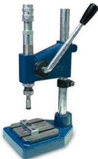
Универсальный механический пресс с ударным механизмом для установки швейной фурнитуры в комплекте с переходниками на метрическую и дюймовую резьбу для турецких и греческих насадок. Предназначен для установки блочек, люверсов, хольнитенов и пуговиц. Ударный механизм - 1300 кг/кв.см
