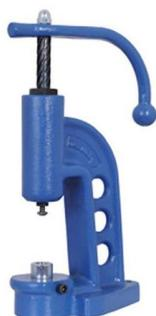
Механический пресс винтовой для обтяжки пуговиц диаметром от 12 мм.
